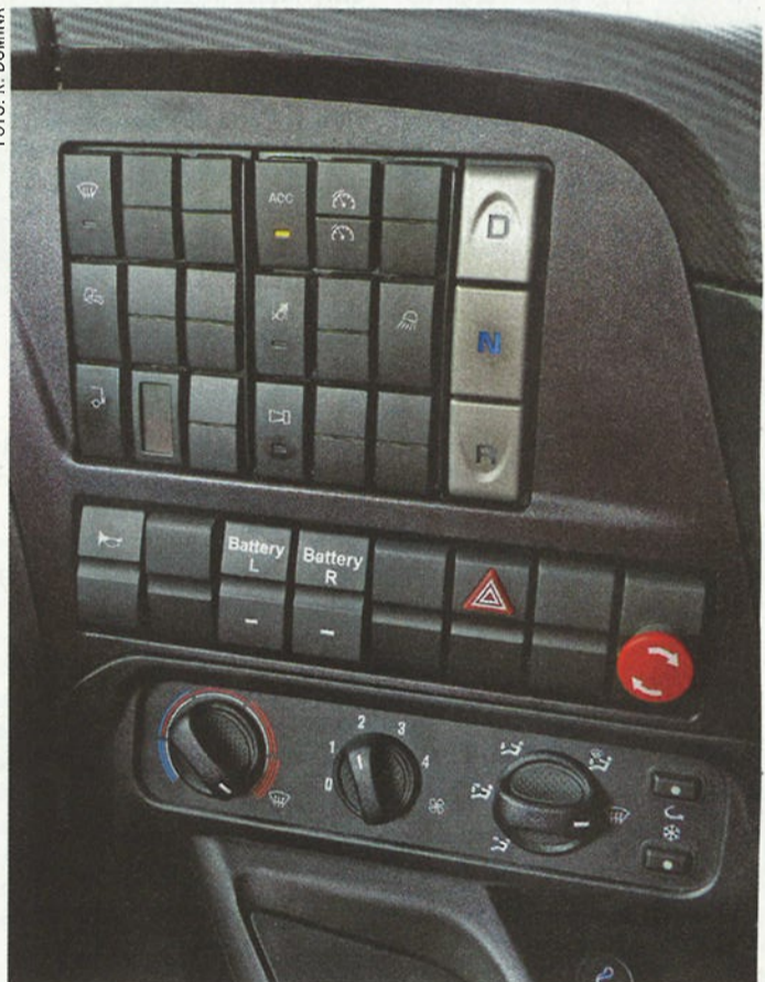
Bis auf den Not-Aus-Knopf ist an den Schalterleisten alles wie immer. Separate Schalter für die beiden Batteriebänke
